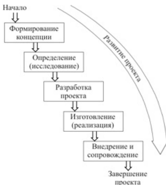
*Рис. 6.2. Каскадная модель жизненного цикла*
